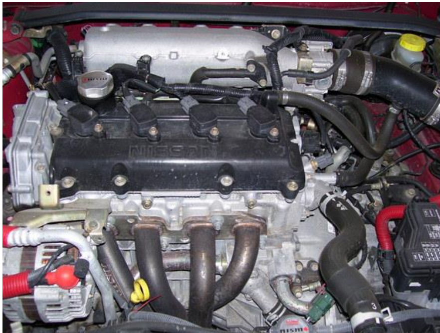
Fig. 4. Catacollecteur dans l'environnement moteur [6]
